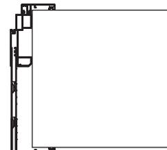
TELAIO MURO FINO A 280 mm
