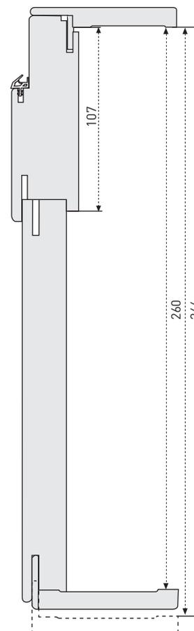
Telaio con coprifilo standard da 107 mm a 131 mm
