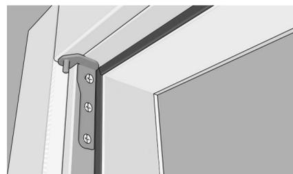
Telaio con coprifilo standard da 106 mm a 120 mm
