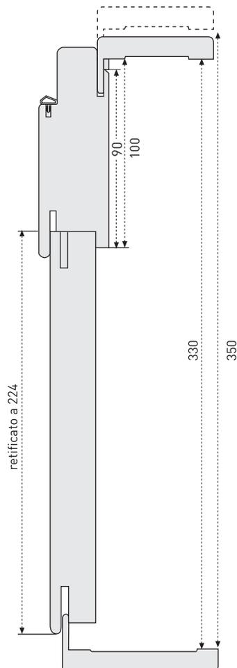
Telaio con coprifilo standard da 100 mm a 130 mm
